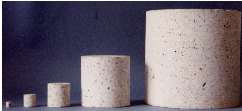
Figura 11: Geometria e dimensioni dei provini testati in compressione in [15].
