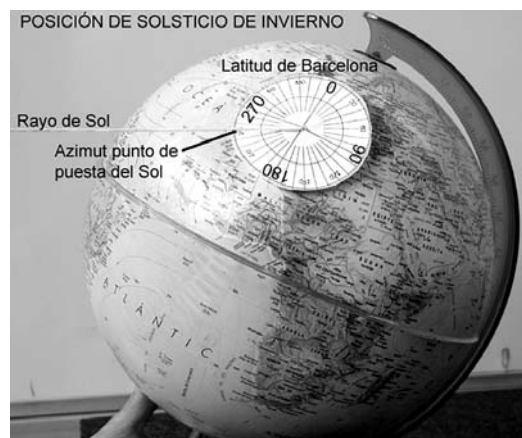
Fig. 13. Ejemplo medición del azimut de la puesta del Sol en la posición de solsticio de invierno, para la latitud de Barcelona.
