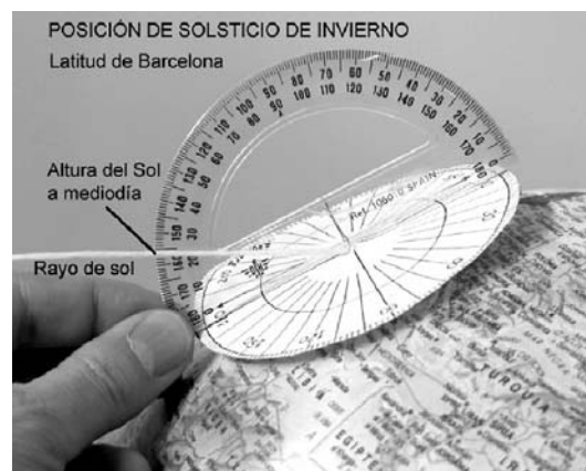
Fig. 12. Ejemplo medición de la altura del Sol a mediodía en la posición de solsticio de invierno, para la latitud de Barcelona.
