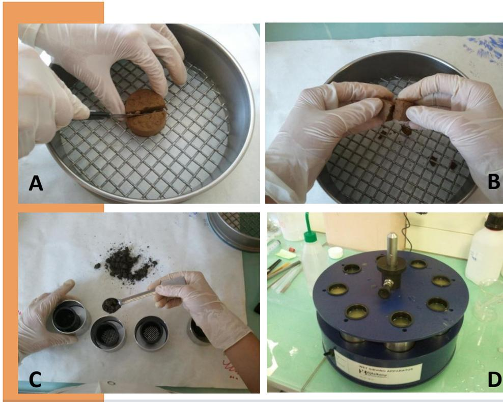
Imagen 5. (A) División de la pastilla de muestra por la mitad. (B) Rotura manual de los agregados del suelo de 16g de pastilla respetando los planos de rotura. (C). Repartición de los 16g de suelo entre 4 tamices de 2mm (D). Proceso de agitación con el aparato de tamización en húmedo Eijkelkamp©. Fuente: propia
