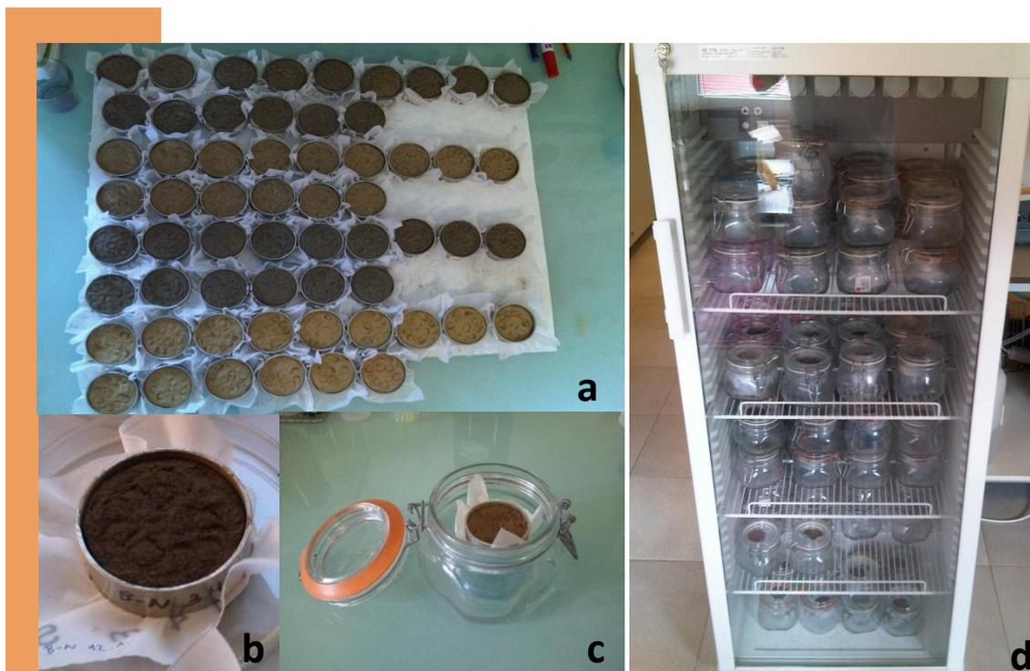
Imagen 3. (a) Los 60 anillos con los diferentes tratamientos listos para poner a incubar. (b) Imagen de uno de los anillos con más detalle. (c) Frasco de incubación con el anillo. (d) Estufa termostatazada con los frascos. Fuente: propia
