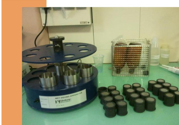
Imagen 4. Aparato de tamizado en húmedo Eijkelkamp® con su batería de tamices de 2mm, 250  $\mu\text{m}$  y 53  $\mu\text{m}$ .
