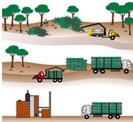
Figura 5: Esquema de l'estellat en planta. Font: Observatori de la biomassa, CPF 2006.
