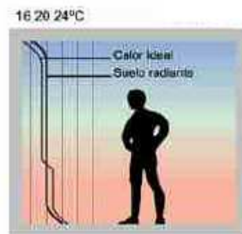
Imatge 9-7: Temperatura per radiació del sòl. Font: Guia Climatización por suelo radiante
