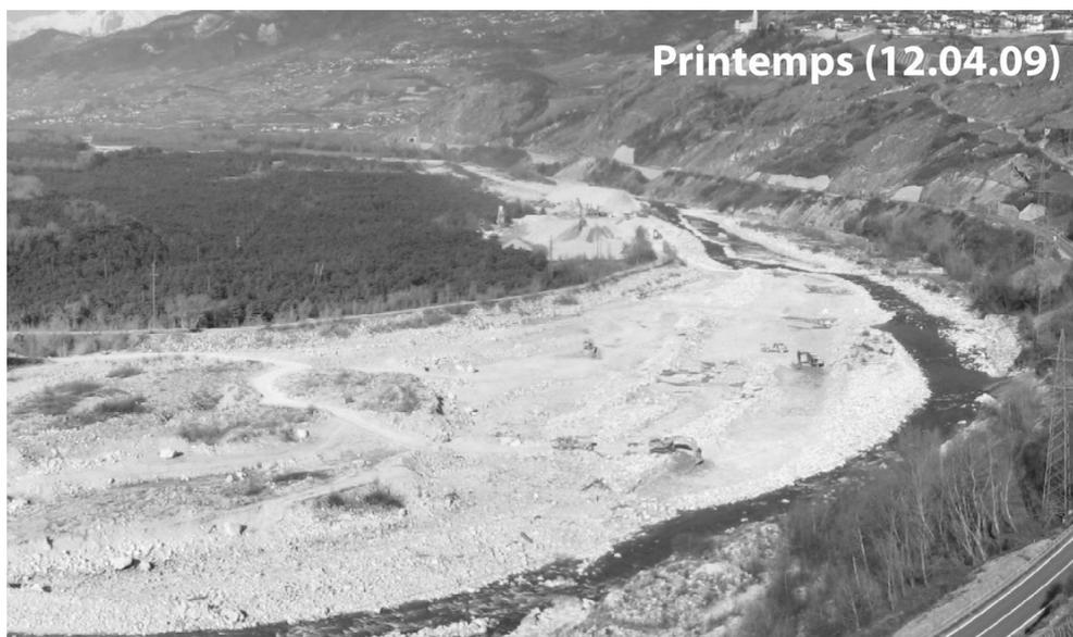
Fig. 9 : Modification saisonnière de la morphologie de la bande active due à l'action anthropique (extraction de graviers au printemps ; Clichés: L. Laigre).
