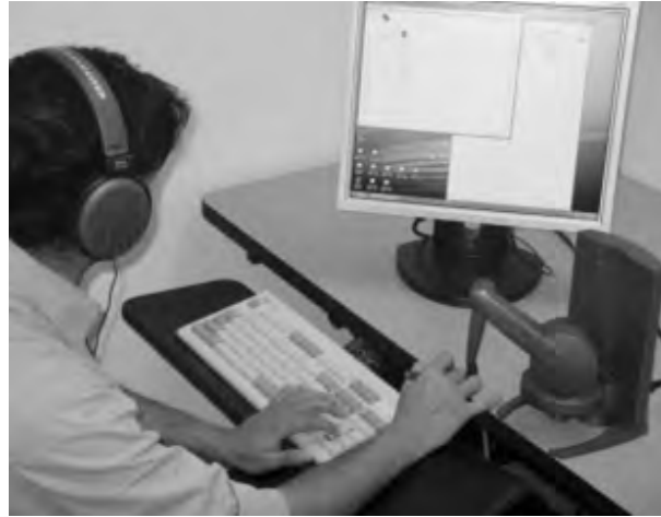
FIGURE 4.6 – L'utilisation du périphérique Phantom Omni dans «BlindAid», un environnement virtuel multimodal pour non-voyants [Schloerb et al. 2010].
