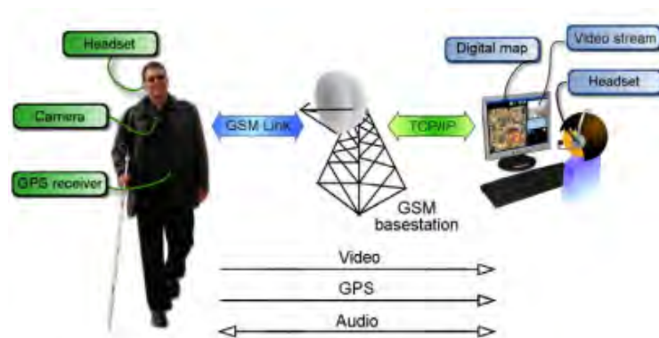
FIGURE 2.8 – L'architecture du système Naviton, avec une partie embarquée par le Déficiant visuel et un module de contrôle géré par un opérateur.
