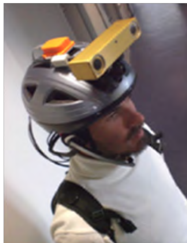
FIGURE 3.12 – L’utilisateur embarque le module de positionnement : La bumblebee et la centrale inertielle placée sur la tête ainsi qu’un PC dans le sac à dos.
