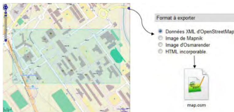
FIGURE 4.2 – Processus d'extraction d'une zone à partir d'OSM sous forme d'un fichier XML.
