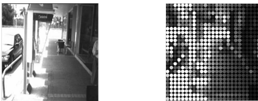
FIGURE 1.4 – Le principe des approches holistique en essayant de présenter l'ensemble des informations de l'environnement (gauche) par une diminution de la résolution (droite)
