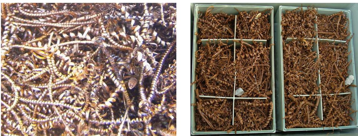
Abbildung 5-4: Eisenspäne vor dem Waschen im MEV
