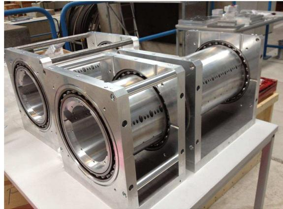
**Abbildung 5.3.:** Links: Querschnitt durch ein PMQ-Linsengehäuse mit den einzelnen Magnetmodulen (orange) im Inneren. Zu sehen sind außerdem die Kugellager (blau), die die Drehung der Linse um die Strahlachse ermöglichen, sowie die Montageplatte darunter, die für die Justage in x-Richtung zuständig ist. Rechts: Die leeren Gehäuse vor dem Zusammenbau. Zu erkennen sind die zahlreichen Löcher für die Justageschrauben.
