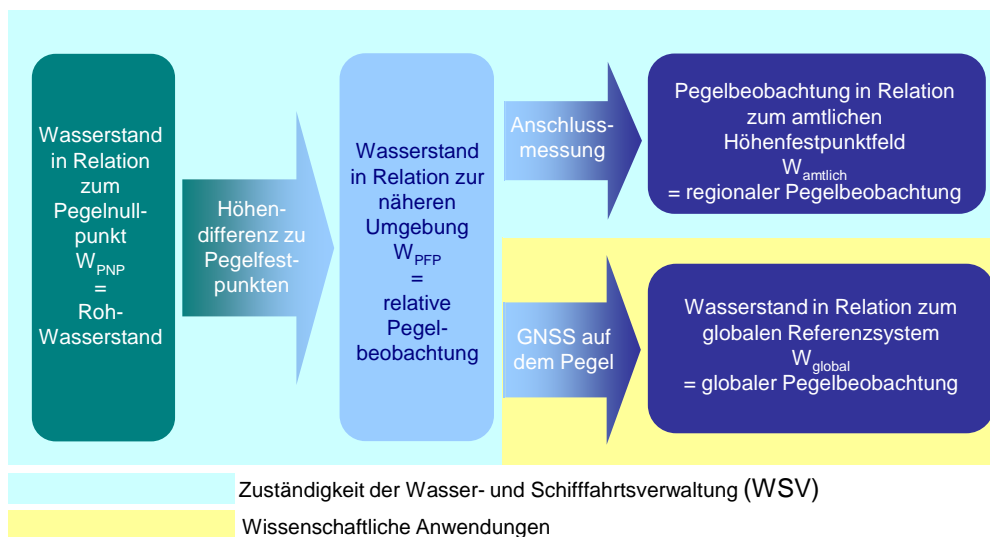
Abbildung 73: Zusammenfassung verschiedener Formen der Wasserstandbeobachtungen bzw. Pegelbeobachtungen in Abhängigkeit der Bezugspunkte ([98], Seite 261).
