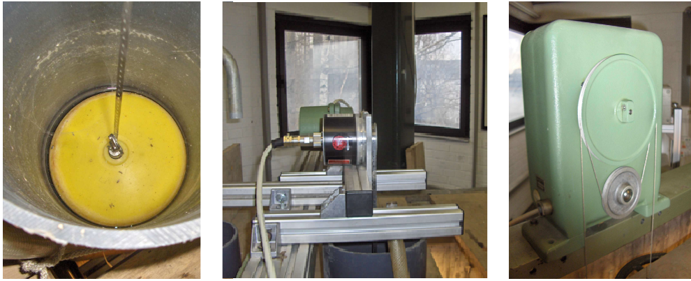
Abbildung 47: Darstellung der Elemente eines Schwimmpegels (v.l.n.r. Schwimmkörper, Pegel Koblenz (digitaler Abgriff), Pegel Koblenz (analoger Abgriff)).
