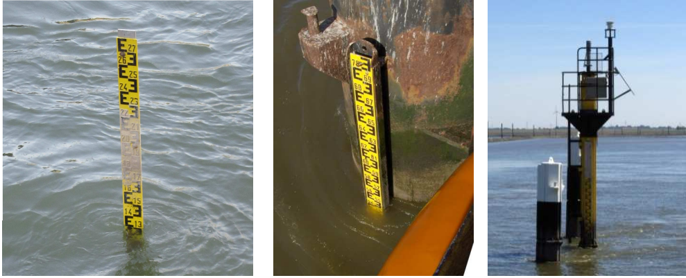
Abbildung 35: Lattenpegel am Rhein (Koblenz), Dukegat (Ems) und Norddeich (Nordseeküste).
