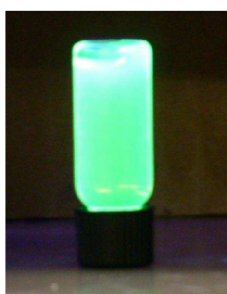
Abbildung 5.47 Fotografie einer Lösung aus OC48-PPV 66 in THF ( c = 1 \text{ mg/mL} ) bei Bestrahlung mit UV-Licht der Wellenlänge 366 nm.
