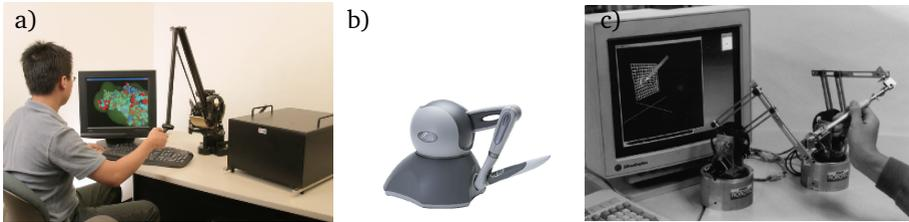
**Abb. 4.2:** Impedanz-gesteuerte Displays mit hybriden Mechanismen: a) Phantom PREMIUM [246], b) Phantom OMNI [246], c) Pen-based Display [121]
