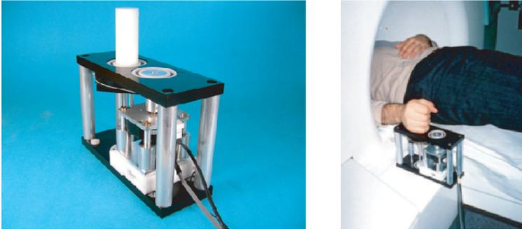
**Abb. 4.5:** MRT-kompatibles haptisches Display mit piezoelektrischem Wanderwellenmotor [34]
