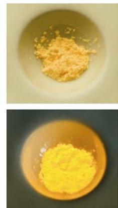
nanokristallinen Mischkristalle  $\text{Ba}_{1.5}\text{Sr}_{0.5}\text{Si}_2\text{N}_5:\text{Eu}^{2+}$  führte zu transluzenten Lumiramic<sup>TM</sup>-Keramiken, mit Phosphorpartikel-Größen um 500 nm.
