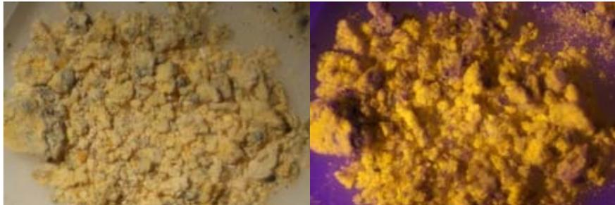
**Abbildung 7-11:** Fotografie der der Verbindung  $\text{Li}_2\text{CaSi}_2\text{N}_4:\text{Eu}^{2+}$  (1 %) unter Tageslicht (links) und UV-Bestrahlung (rechts,  $\lambda = 450 \text{ nm}$ ). Verunreinigungen (dunkle Stellen) zeigen keine Lumineszenz.
