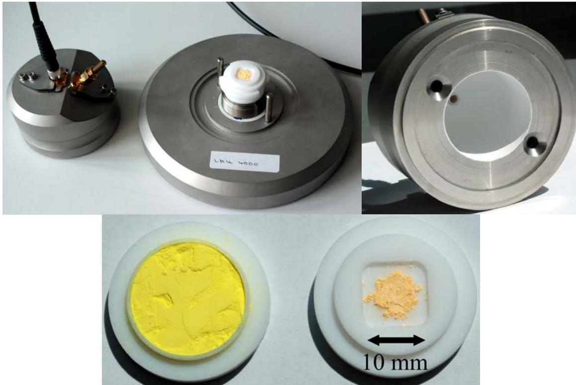
**Abbildung 2-10:** Aufsicht Probenkammer (oben links); Innenansicht Probenkammer (oben rechts); präparierte Proben (unten).
