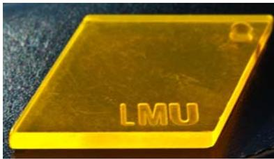
**Abbildung 6-10:** PMMA-Platte mit Farbstoff. An den Kanten ist ein vermehrter Lichtaustritt zu beobachten.
