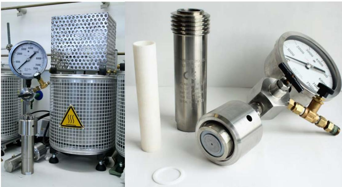
**Abbildung 2-7:** Autoklav mit Manometer und Standofen mit Splitterschutzkäfig (links), Komponenten des Autoklaven (rechts).
