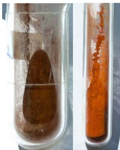
**Abbildung 5-2:**  $\text{Eu}(\text{NH}_2)_2$ : dargestellt in  $\text{NH}_3(l)$  ( $-52\text{ }^\circ\text{C}$ , 5 d, links); dargestellt aus  $sc\text{NH}_3$  ( $150\text{ }^\circ\text{C}$ , 300 bar, 5 d, rechts).
