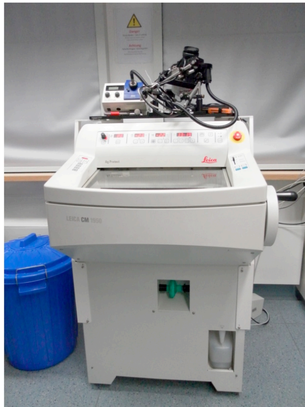
Abbildung 10: Kryotom (Leica CM 150) mit angebrachter CCD-Kamera.
