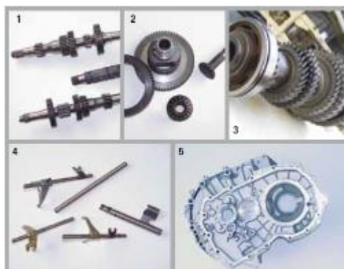
Figura 12 – Componentes da uma Caixa de Velocidades (1. Árvores; 2. Caixa Diferencial; 3. Carretos; 4. Eixos; 5. Cárter), (fonte: Renault CACIA, 2013).
