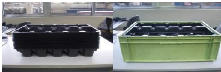
Figura 19 – Exemplo de termoformados e a sua aplicação numa embalagem PE.
