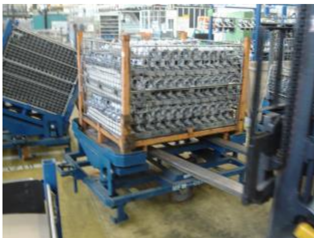
Figura 22 - Exemplo de contentor cheio de brutos a ser deixado, por empilhador, numa das linhas que já tem bases rolantes.
