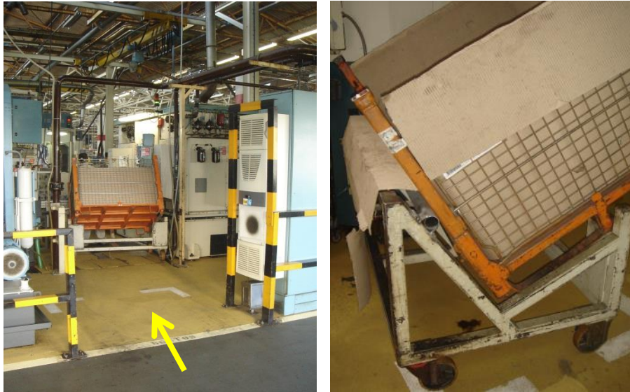
Figura 43 - Entrada de um contentor de brutos corpo k70 (esquerda) e perspetiva estrutura fixa com rodas (direita).
