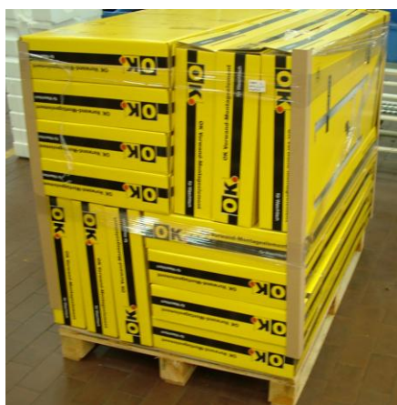
Figura 24- Exemplo de paletização com cantos de cartão
