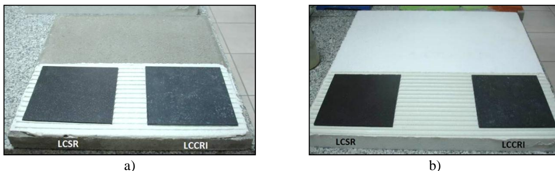
Figura 25: Colagem das peças cerâmicas sobre: a) Placa de betão; b) Placa de EPS 100.
