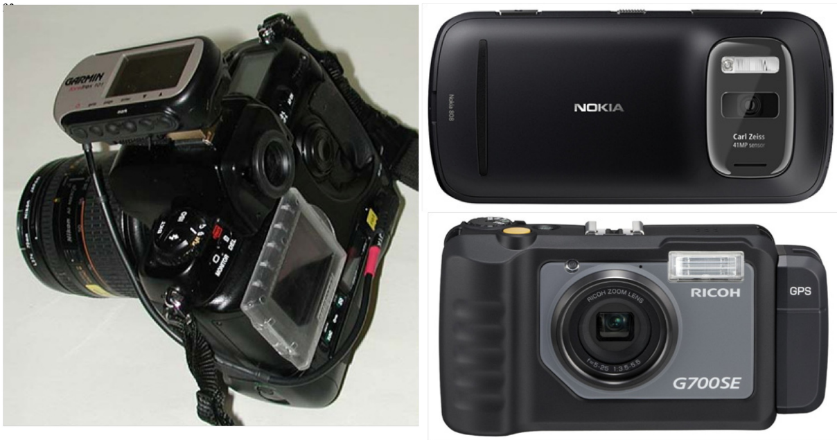
Abbildung 2: Verschiedene Wege zum getaggtten Foto - Nikon D1x mit Garmin Foretrex 101, Nokia 808 Pureview, Ricoh G700SE (von links nach rechts unten) 23
