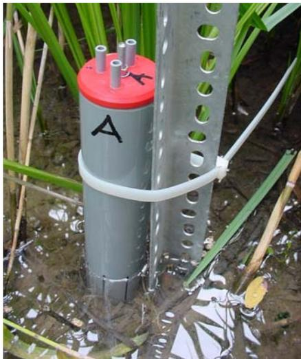
*Abb. 3.2 Beprobungssonde im Pflanzenklärgebiet. Die drei durch den Deckel ragenden Röhrchen haben verschiedene Längen und ermöglichen eine Probengewinnung aus den unterteilten Kammern in den verschiedenen Tiefen. (Photo: T. Vögli September 2003)*
