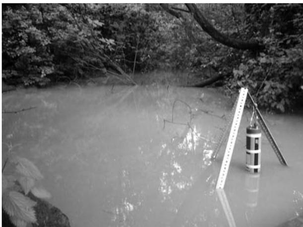
*Abb. 3.1 Die YSI-Multiparameter-Sonde, hier im Teichbächlein vor dem Einlauf ins Pflanzenklärgelände (PG). Für das Experiment „Trübungswelle“ wurde damit die Trübung in 10-Minuten-Intervallen (vor und nach dem PG) aufgezeichnet. (Photo: U. Geissbühler 3.6. 2004)*
