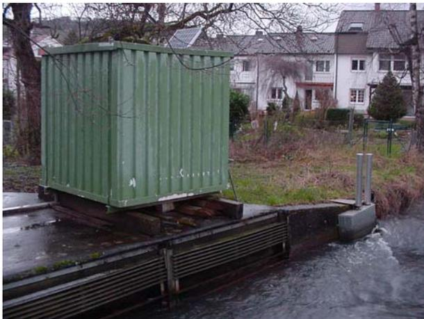
*Abb. 3.3 Der „Eingangswächter“ im Mühlebach. Im Wasser (innerhalb des Gitterkäfigs am rechten Rand) befindet sich die Trübungs- und UV-Extinktions-Sonde, im daneben stehenden Container sind die dazugehörigen Steuerungs- und Aufzeichnungsgeräte sowie der automatische Probensammler untergebracht. (Photo: U. Geissbühler 26.2.2001)*
