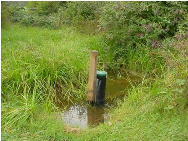
*Abb. 2.6 Der grössere der beiden neu geschaffenen Tümpel in der Wasserstelle „Hintere Stellmatten“. Erkennbar ist das Polyethylen-Rohr zur Installation einer YSI-Sonde zur Aufzeichnung der Wasserqualität (vgl. Kap. 3.8). (Photo: U. Geissbühler 4.9.2002)*
