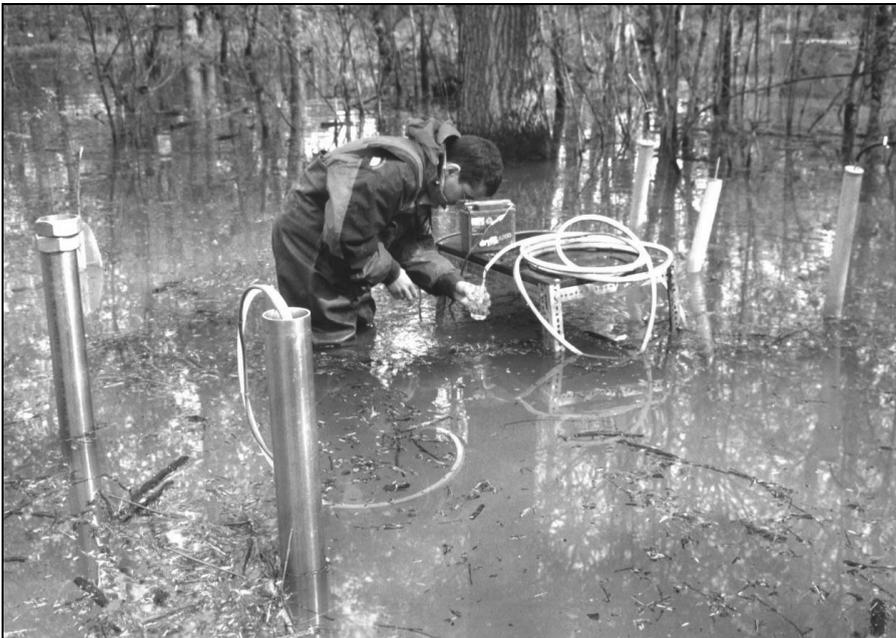
Abb. 2-24: Der Autor bei der Grundwasserprobennahme in VW1.
