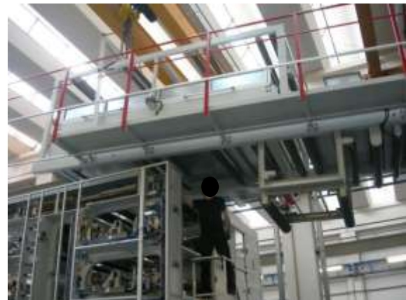
Foto 58. Montaggio gruppo ponte sopra gruppo stampa.
