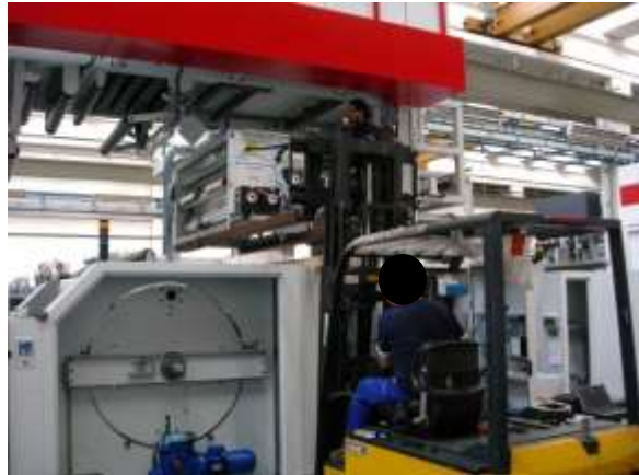
Foto 46. Montaggio trattamento corona sotto il ponte con utilizzo del muletto.
