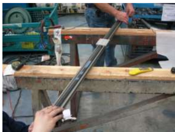
Foto 50. Rilavorazione asta del gruppo movimentazione doppio controllo registro.
