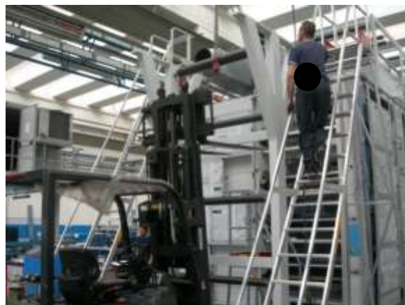
Foto 31. Montaggio gruppo montante sx con utilizzo del muletto.
