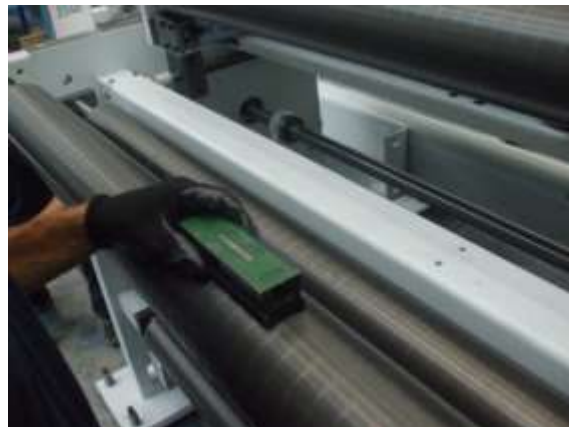
Foto 44. Adeguamento rullo con utilizzo di bolla centesimale.
