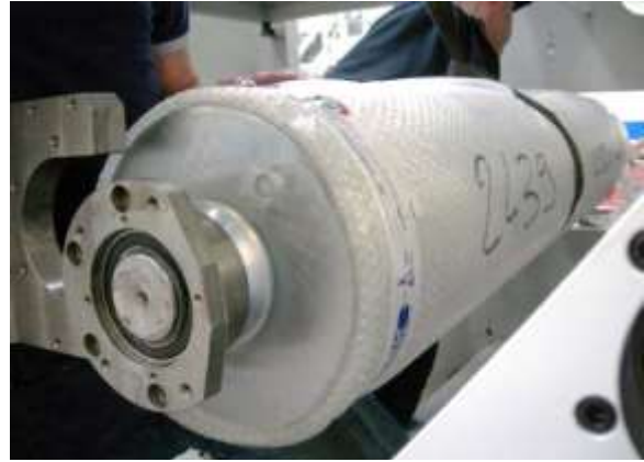
Foto 54. Difficoltà di montaggio dei cilindri di pressione centrali a gruppo stampa chiuso.
