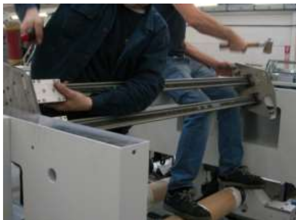
Foto 2. Montaggio movimentazione doppio controllo registro in macchina.
