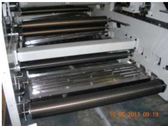
Foto 24. Vista cassetta d'essiccazione e rulli costituenti il gruppo lisce.
