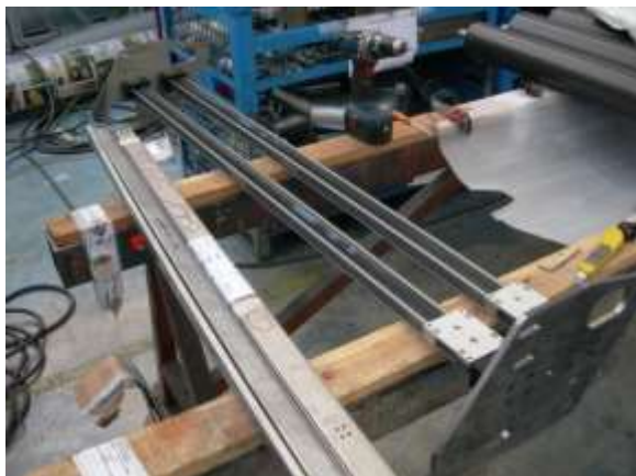
Foto 47. Premontaggio movimentazione doppio controllo registro.
