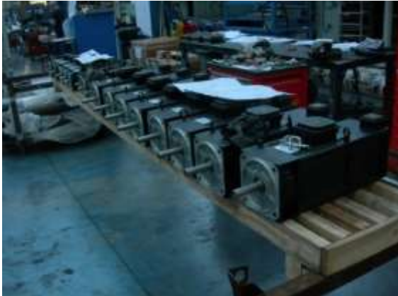
Foto 79. Predisposizione motori su piedistallo per eseguire il loro premontaggio.
