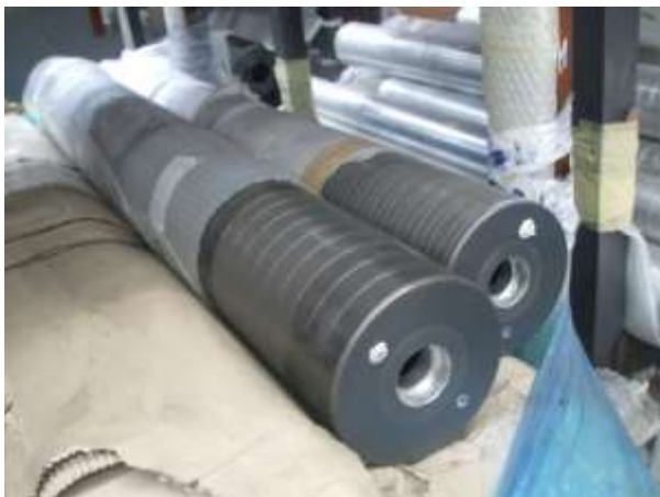
Foto 61. Rulli in magazzino adattati per sostituire i rulli mancanti.
