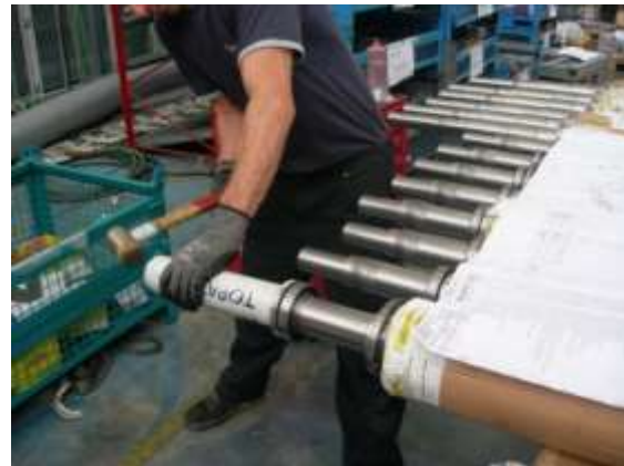
Foto 78. Premontaggio cilindri anilox e clichè.
