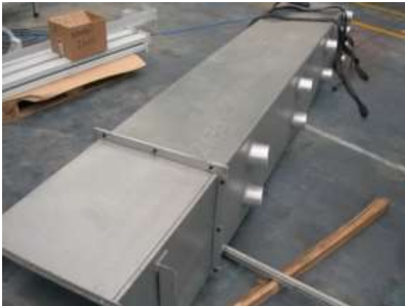
Foto 26. Condotto d'essiccazione principale.
