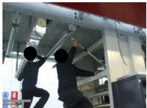
Foto 42. Allineamento rullo con rullo utilizzo del comparatore.
