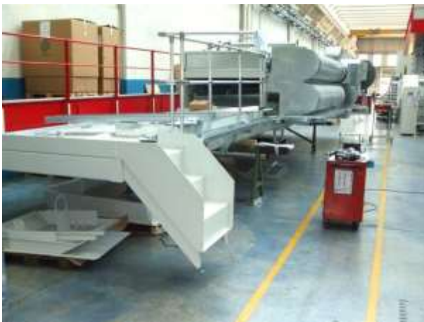
Foto 73. Gruppo ponte posizionato momentaneamente accanto alla cella di lavoro in attesa di essere posizionato sopra la macchina.
