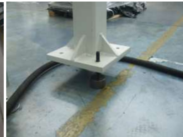
Foto 40. Piattello alto per sopperire alla corta lunghezza del montante.
