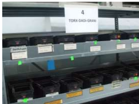
Foto 6. Scaffale di contenitori kanban in magazzino per ripristino contenitori in campata.
