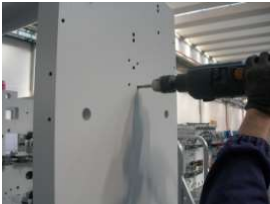
Foto 32. Forature eseguite dagli operatori in campata sulle spalle del gruppo calandra.
