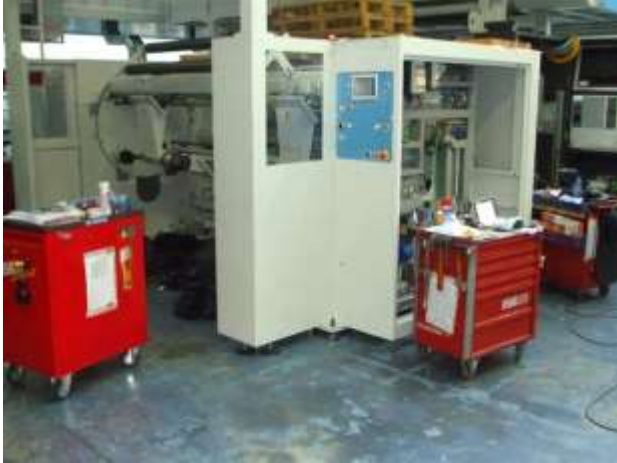
Foto 76. Carrellini contenenti gli attrezzi di ogni singolo operatore utilizzati per le fasi di montaggio in campata.
