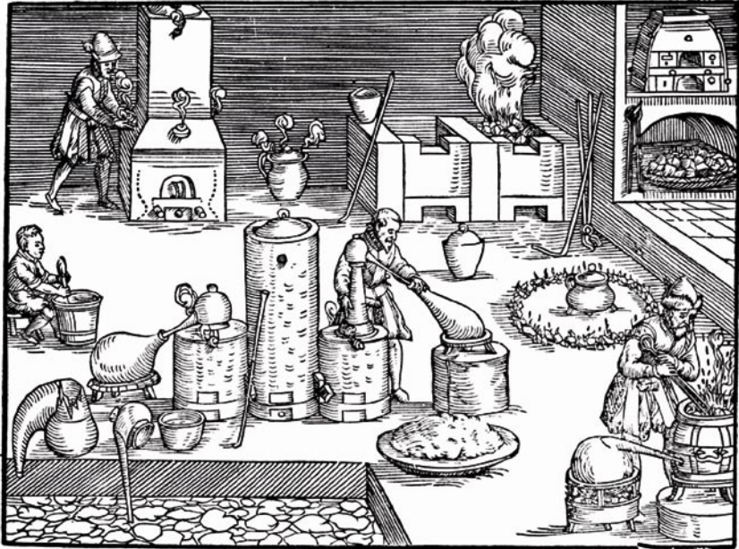
Figure 9 : un atelier d'essayeur à la fin du XVI e siècle d'après Lazarus Ercker (1580). Appareils de distillation au premier plan (alambic, retorte et fourneaux), au second plan four de cémentation et four de fusion (avec un creuset), dans le fond à droite, un four de coupellation.
