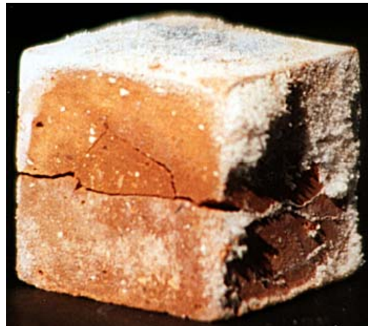
Figura 8.3.2. Aspecto de la fisuración y de las eflorescencias superficiales de sales de un ladrillo de Vizar (VH9) después del ensayo de cristalización de sales.
