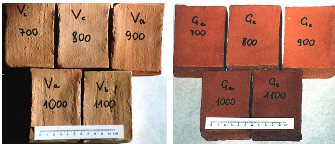
Figura 6.2. Ladrillos de Viznar (a la izquierda) y e Guadix cocidos entre 700 y 1100 °C.
