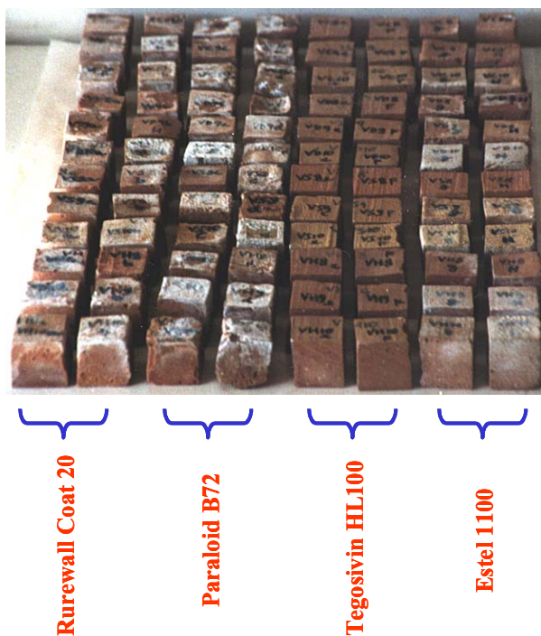
Figura 9.4.1. Aspecto final de las muestras de Viznar después de ser sometidas a los ensayos de cristalización de sales.
