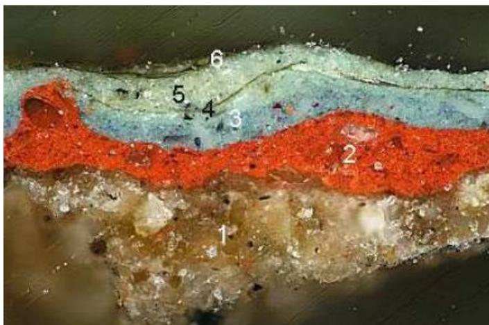
**Fig. 2.** Corte transversal de la muestra SA-1 B, procedente de la obra Virgen de Guadalupe.
