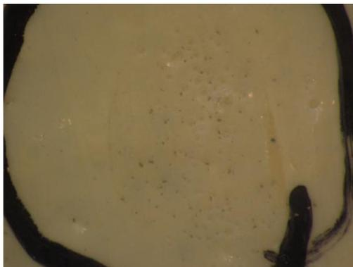
**Fig. 14.** Probeta tipo C inoculada con una mezcla de *P. globulus* y *Eurotium* sp. donde se puede observar el crecimiento fúngico (18X).
