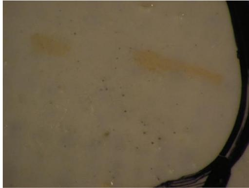
**Fig. 12.** Probeta tipo B inoculada con una mezcla de *P. globulus* y *Eurotium* sp., donde se puede observar el crecimiento fúngico (18X).
