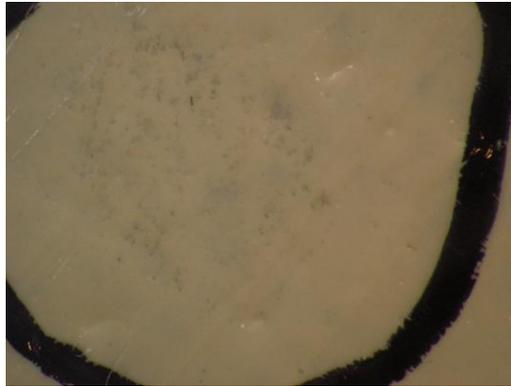
**Fig. 13.** Probeta tipo C inoculada con una mezcla de *P. globulus* y *Penicillium* sp., donde se puede observar el crecimiento fúngico (18X).
