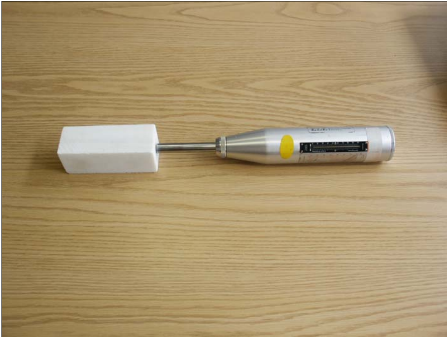
Figura 5.8. Realización del ensayo de medida de dureza superficial mediante esclerómetro.
