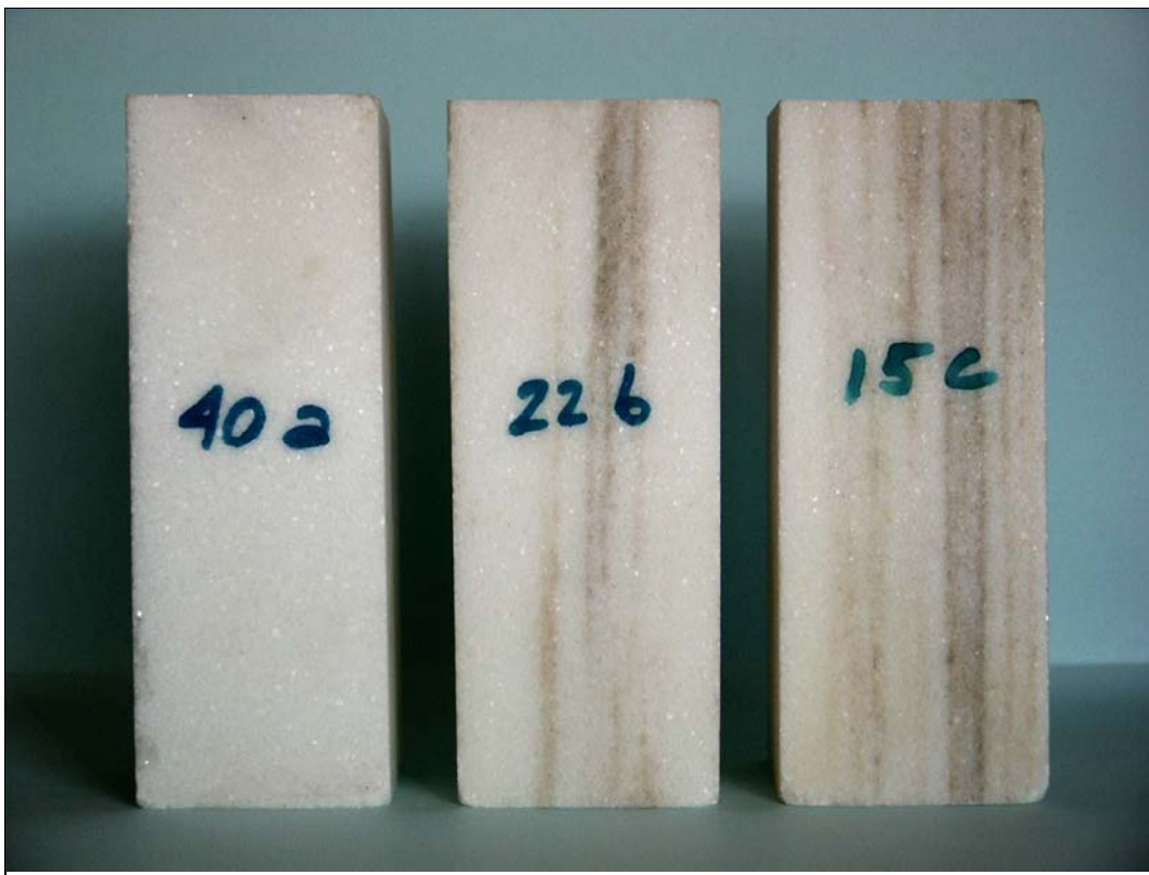
Figura 5.1. Detalle de los grupos de probetas establecidos: A (40a, ausencia de bandeo), B (22b, bandeo medio) y C (15c, bandeo abundante).
