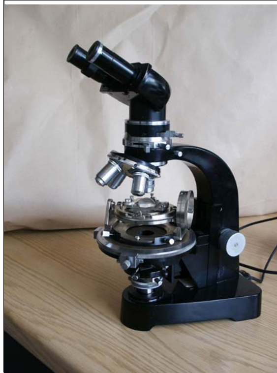
Fig. 5.2. Vista de microscopio con platina utilizado en la determinación de la orientación del eje c cristalográfico.
