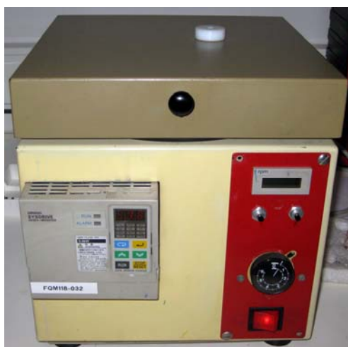
Figura 4.6 Dispositivo de giro para la preparación de membranas circulares.
