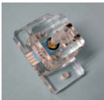
Figura 1.7 Celda de flujo para determinaciones electroquímicas con electrodos serigrafados de Dropsens.
