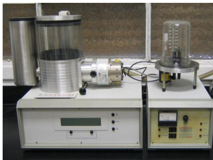
**Figura 18.** Criodesecador utilizado para el procesamiento de las células analizadas en esta Tesis Doctoral.
