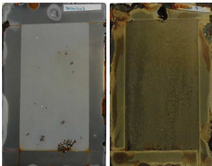
Obr. 66 - Vzhled nátěrové hmoty s Zn_3(PO_4)_2 + čistý NaOH – Vlevo: Akrylová nátěrová hmota bez porušení nátěrového filmu; vpravo: Alkydová nátěrová hmota bez porušení nátěrového filmu (doba expozice 480 hodin)
