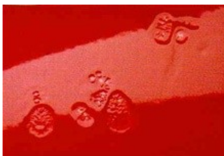
Obr. 33 - Kráterky na povrchu nátěrového filmu [63]
