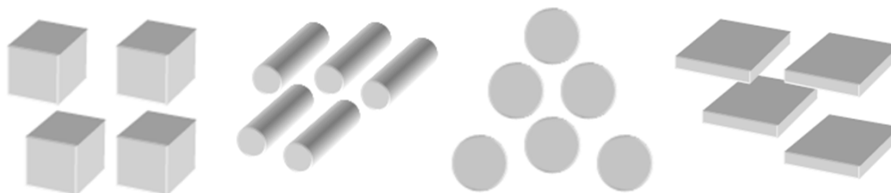
Obr. 11 – Primární částice (zleva: kubické, jehlicovité, izometrické a neizometrické [6])
