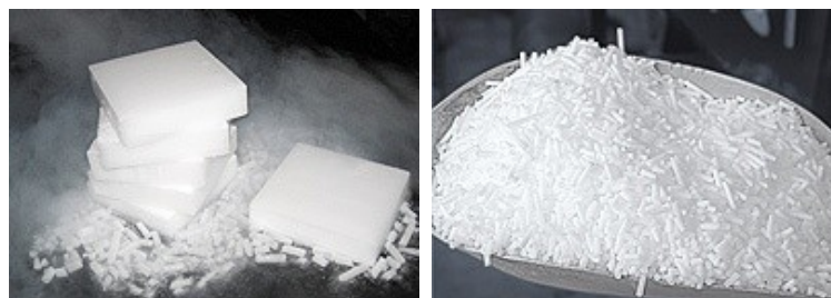
Obr. 22 – Granulace suchého ledu kryomletím [47]
