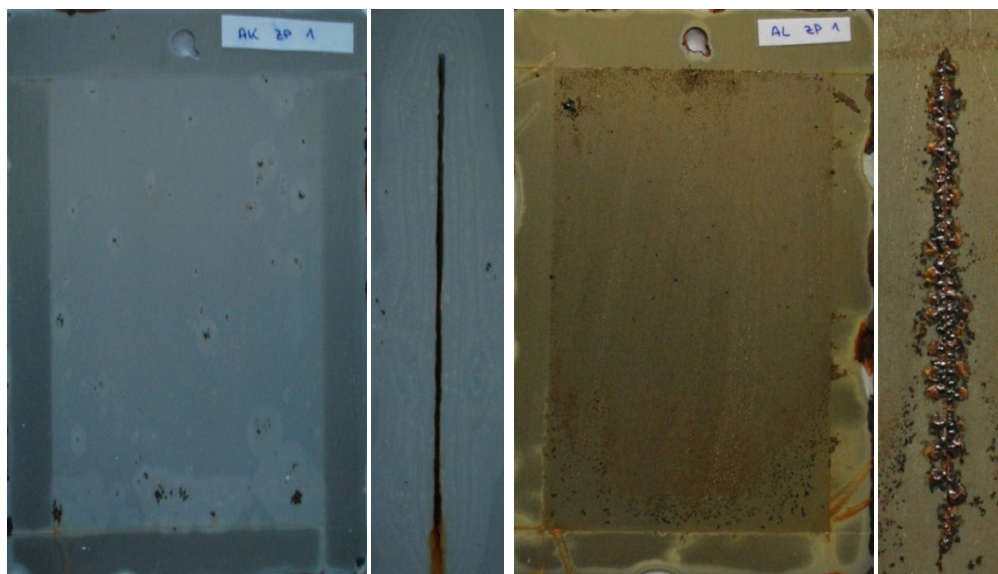
Obr. 62 – Vzhled nátěrové hmoty s Zn_3(PO_4)_2 - Vlevo: Akrylová nátěrová hmota bez a s porušením nátěrového filmu; vpravo: Alkydová nátěrová hmota bez a s porušením nátěrového filmu (doba expozice 120 hodin)
