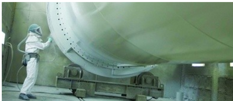
Obr. 31 - Ilustrace nanášení nátěrové hmoty pneumatickým stříkáním [62]
