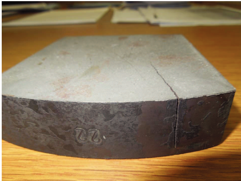
Obr. 22 Šíření povrchové trhliny
