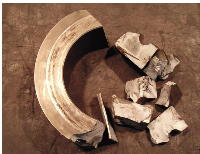
Obrázek 20 Zničený válec vlivem trhlin
