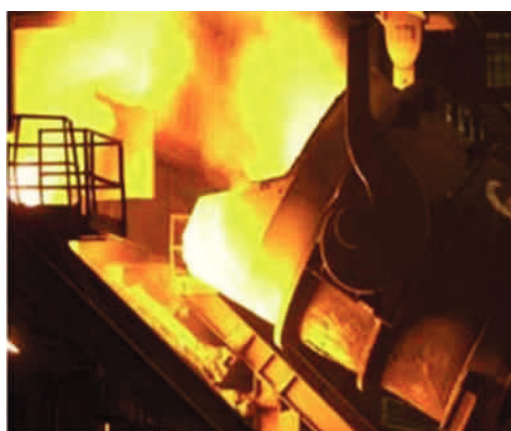
Obrázek 2 Tavba oceli v kyslíkové konvertorové ocelárně [18]
