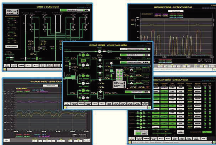
Obrázek 41 Software řídicí chlazení kapaliny na válcovací trati
