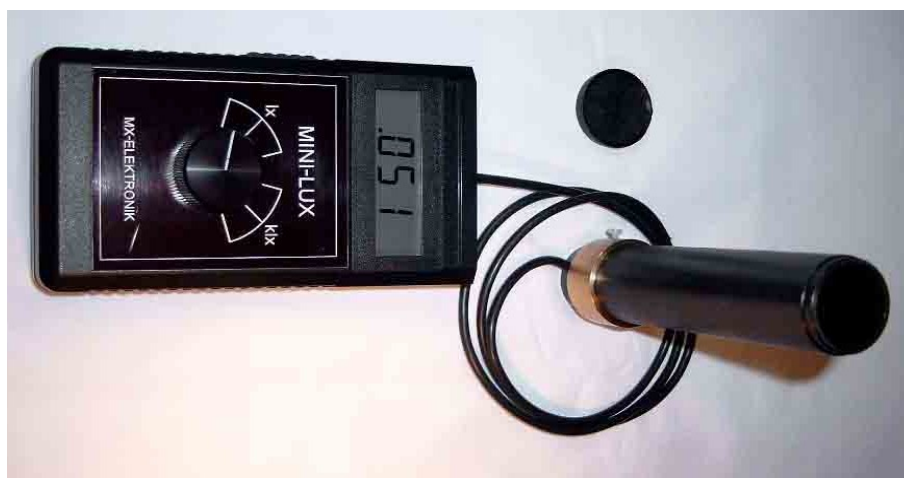
Obr. 19: Příklad luxmetru s nástavcem pro měření jasů.
