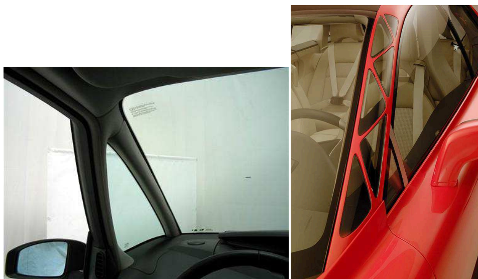
Obr. 5 Zleva dvojitý sloupek (Renault Grand Espace) a zprava žebrovitý sloupek (Volvo SCC) [10]
