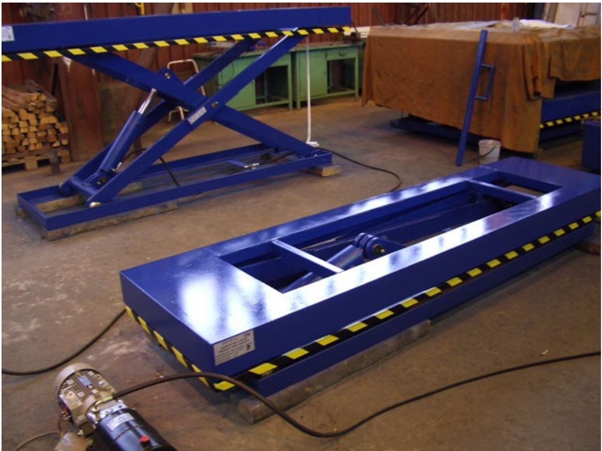
Obr. 2 Nůžkový zvedák ve zvednutém a složeném stavu [10]
