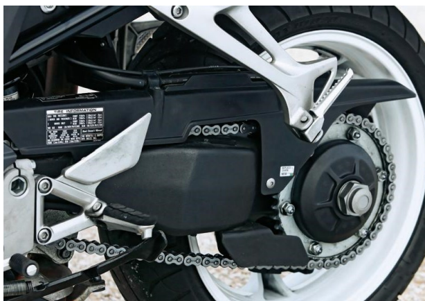
Obrázek 1.5 Jednoramenná vidlice Honda VFR 800 [19]
