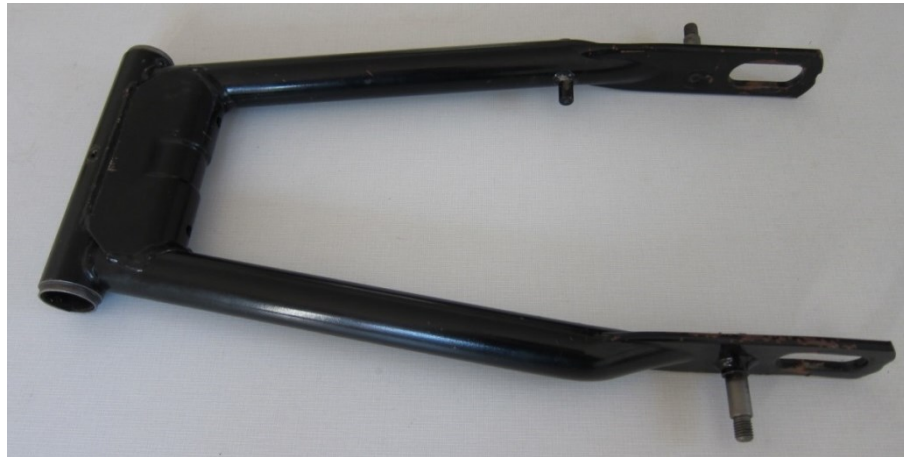
Obrázek 1.9 Dvouramenná kyvná vidlice motocyklu Jawa 350/634
