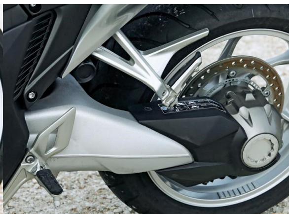
Obrázek 1.6 Jednoramenná vidlice Honda VFR 1200F [20]
