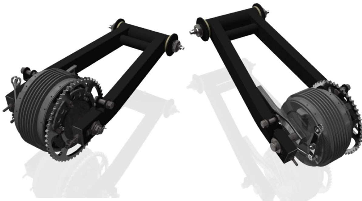
Obrázek 2.2 Sestava navrženého celku i s nábojem kola a bubnovou brzdou
