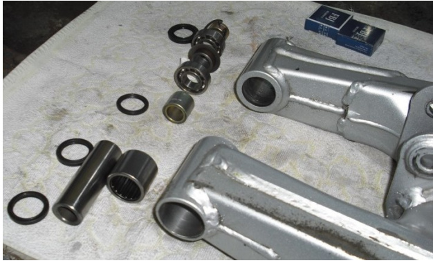
Obrázek 1.7 Uložení vidlice na jehlových ložiscích [21]
