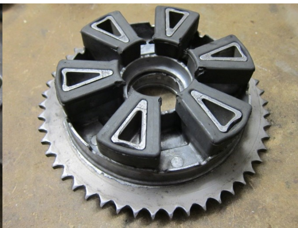
Obrázek 1.14 Rozeta Jawa 350/634, celkový pohled s tlumiči záběru
