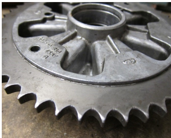
Obrázek 1.13 Rozeta Jawa 350/634, detail zalití věnce
