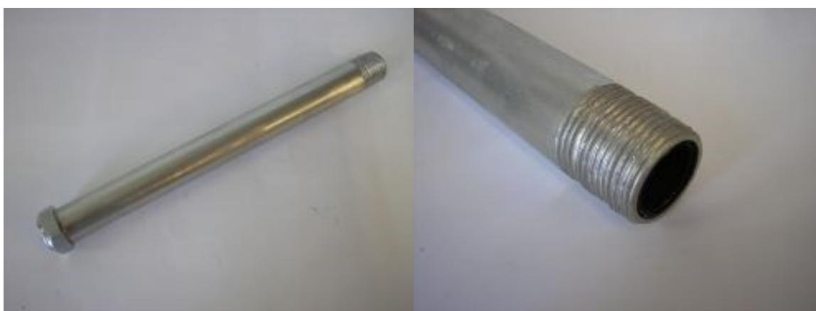
Obrázek 6.1 Čep kyvné vidlice Jawa 350/634; detail závitu [25]
