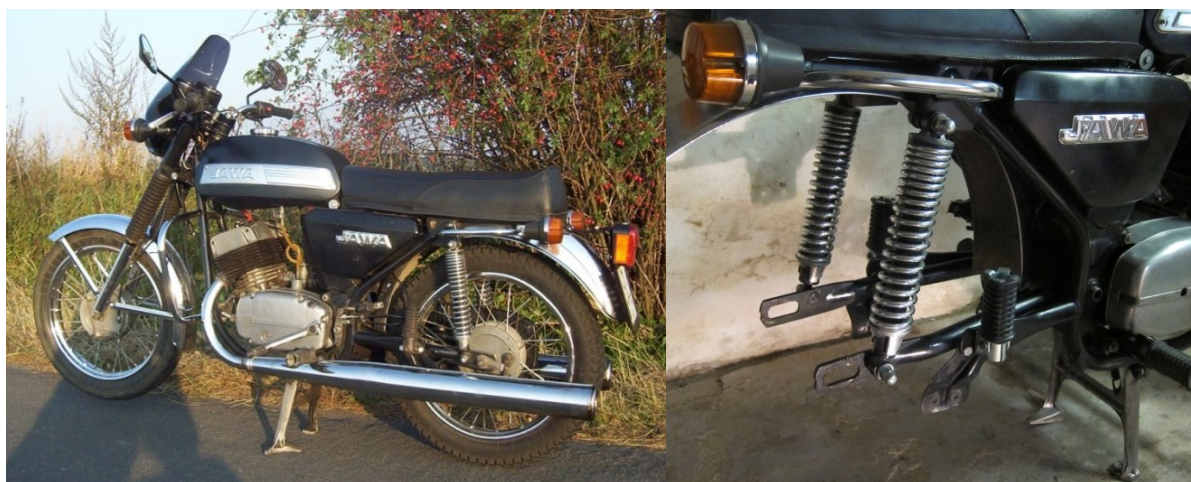
Obrázek 1.2 Klasická dvouramenná kyvná vidlice s dvojicí tlumičů
