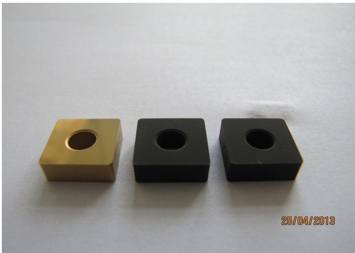
Obr. 15 - vyměnitelné břitové destičky, zleva vzorek č. 1, č. 2 a č. 3
