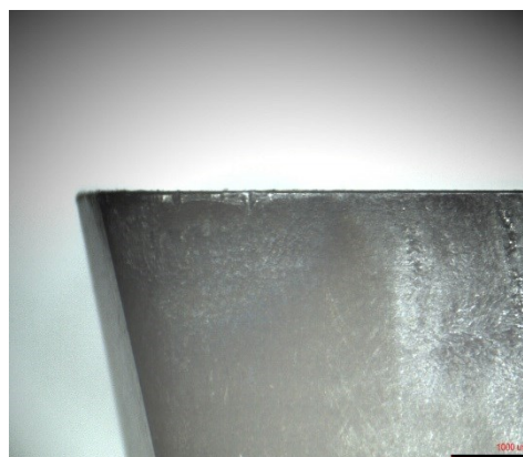
Obr. 32 – vzorek č. 3 hřbet po 78 min.
