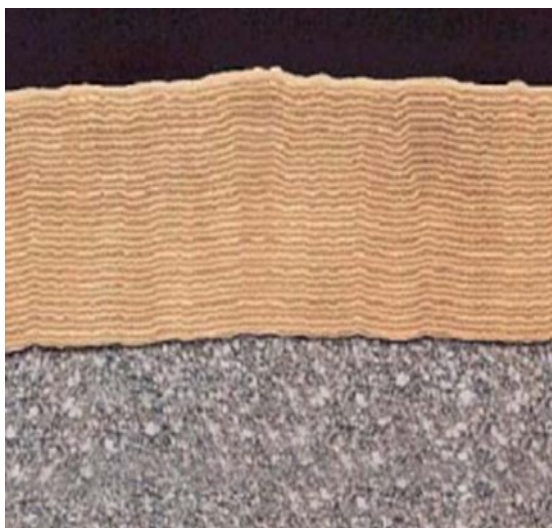
Obr. 4 - multivrstvý povlak TiN/TiCN [8]
