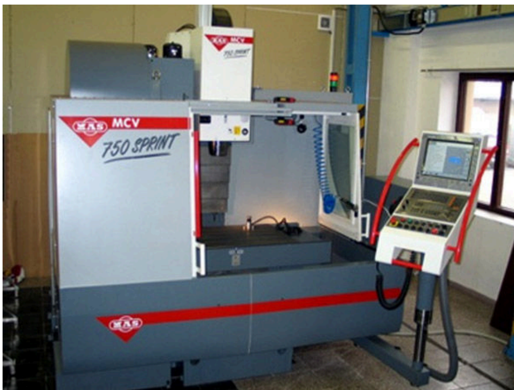
Obr. 3.4 CNC obráběcí centrum – MAS MCV 750 SPRINT[5]
