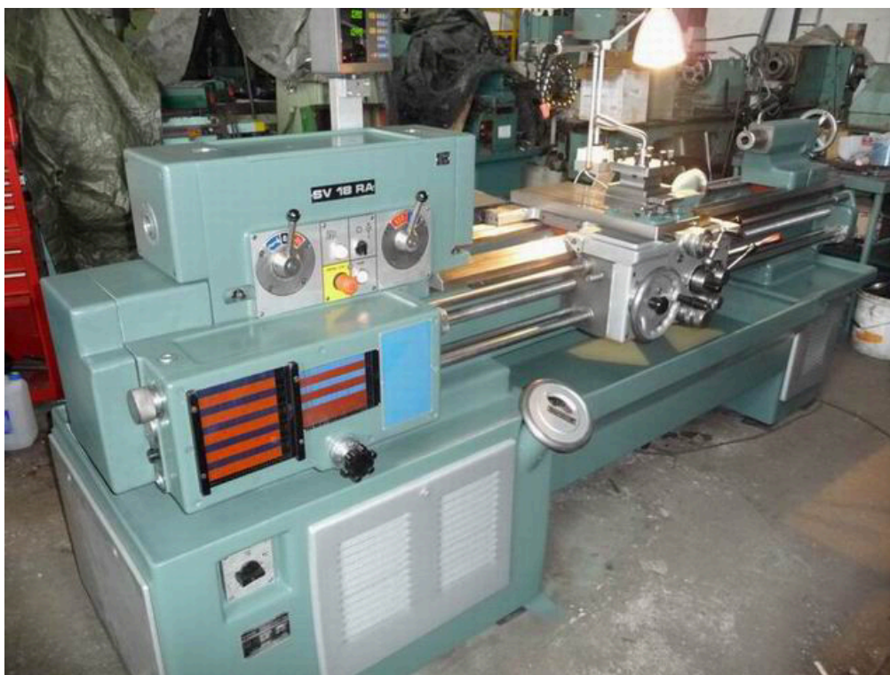
Obr. 3.3 Soustruh SV 18 RA [3]
