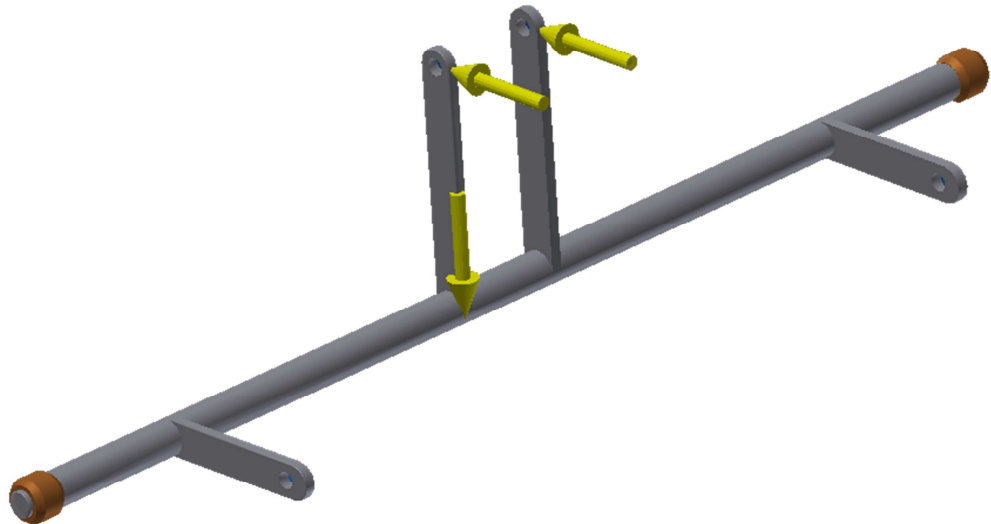
Obr. 7-6 Zobrazení všech zatěžujících sil
