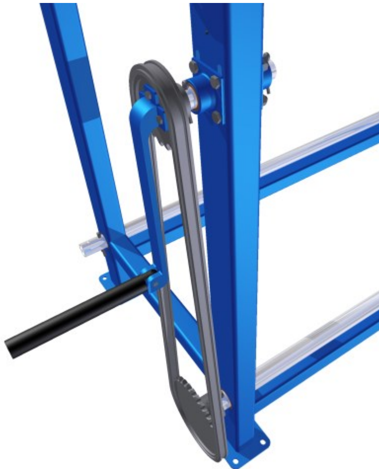
Obr. 3.3 – Řetězový převod s napínáním a skládací klikou
