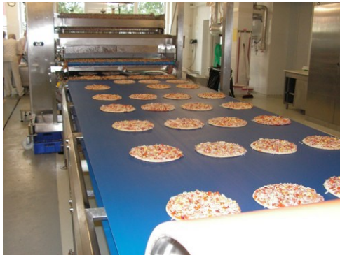
Obr. 2.2 - Pásový dopravník kusového materiálu [01]
