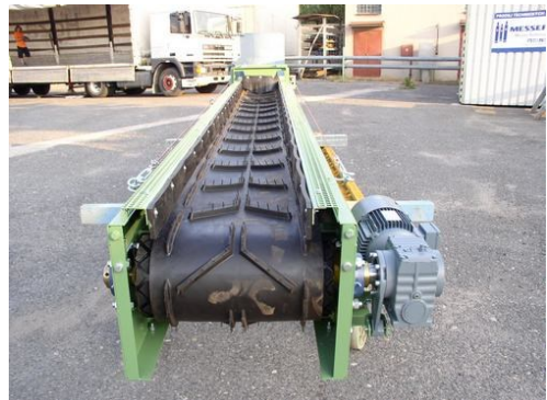
Obr. 2.3 - Pásový dopravník sypkého materiálu [01]
