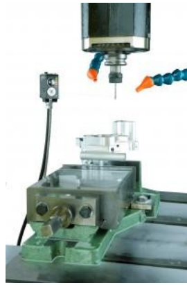
Obr 7 :Přístroj TRS1 pro monitorování stavu řezného nástroje při obrábění (Renishaw)
