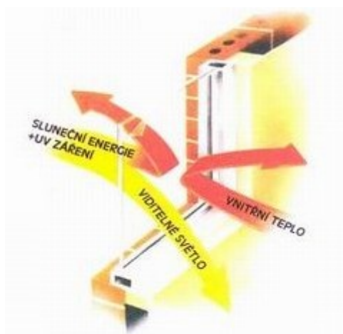
Obr. 2.4 Znáornění průniku světla a odrazu vnitřního tepla fólií
