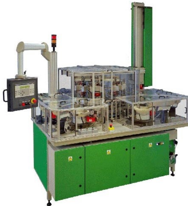
Obr. 5 - Montážní automat pro elektrotechnické součástky [8]
