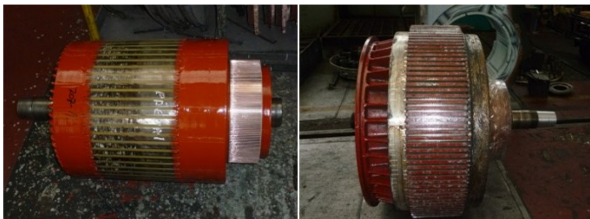
Obr. 7 - Příklad provedení rotoru TE 015 (vlevo) a rotoru TD 802 (vpravo)
