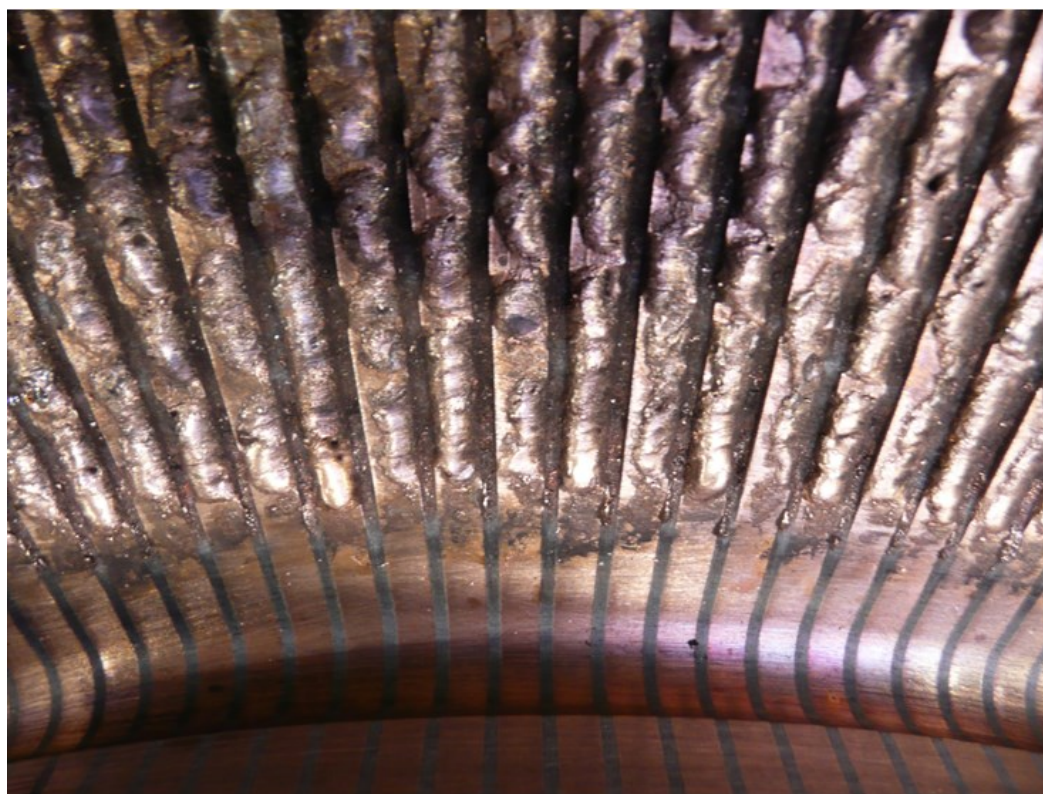
Obr. 10 - Svislá část komutátoru po prořezání
