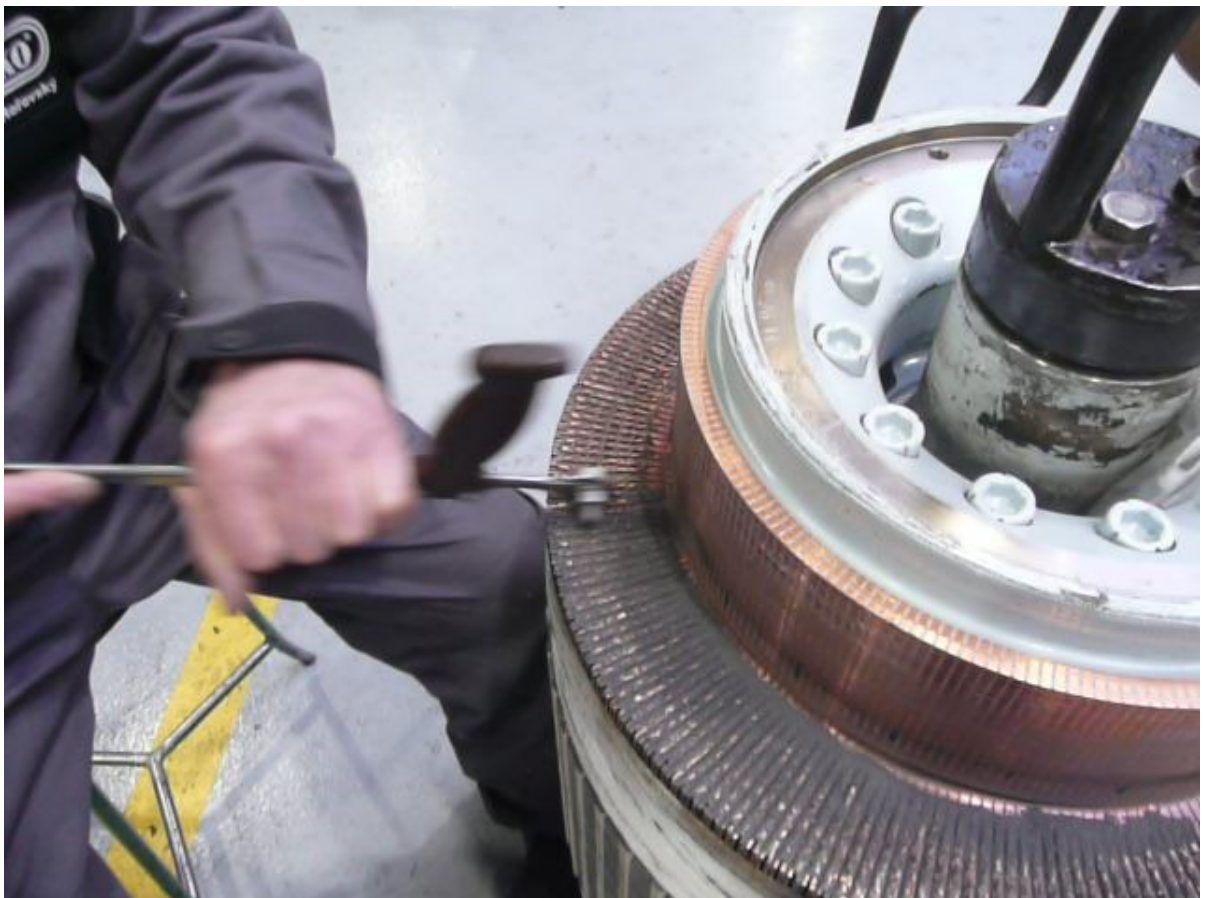
Obr. 30 – Prořezávání izolace svislé části komutátoru
