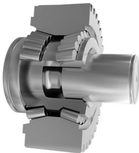
Obr. 3.6 - Uložení satelitu v pružném čepu od společnosti TIMKEN [12]
