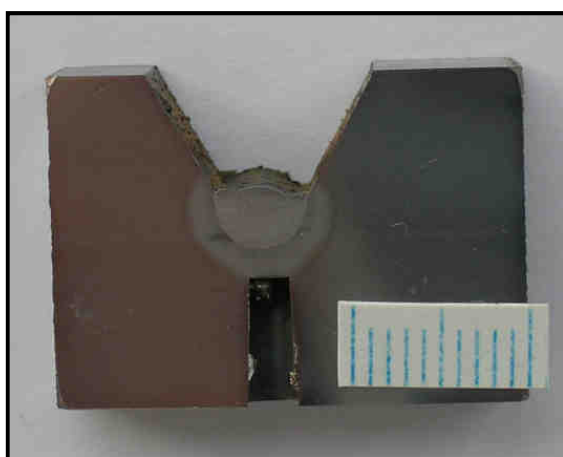
Obr. 20: Makrostruktura vzorku 3-VDK-245-1-1
