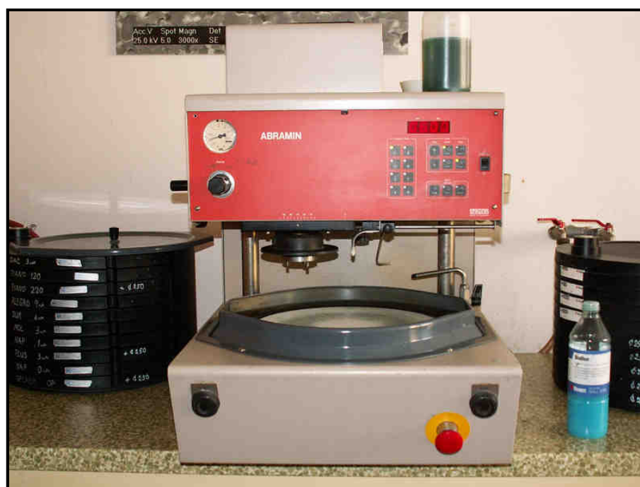
Obr. 18: Brousící zařízení Abramin od firmy Struers
