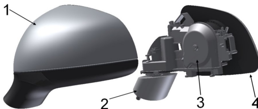
Obr. 2.5 Model vnějšího zrcátka: 1 – Kryt zrcátka, 2 – Držák zrcátka, 3 – Skříň motoru, 4 – Odrazová plocha
