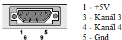
Obr. 29 Zapojení pinů konektoru encoderu2
