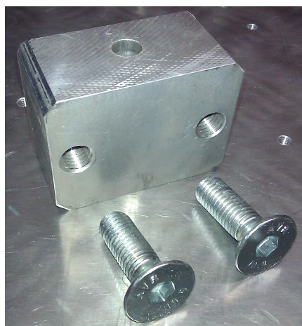
b) Hotový hranol se zápusťnými šrouby M12
