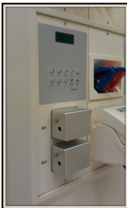
Obr. 12 Modul BTM jako součást ledviny FRESENIUS 4008S
