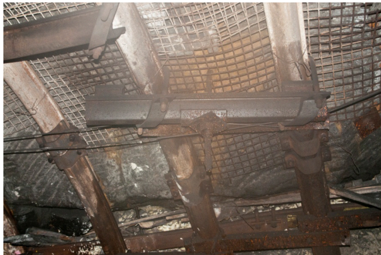
Obrázek č. 8 Stropnice SPK
